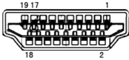
19-polet signalkabel til farvedisplay
