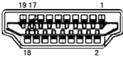
Kabel sygnałowy wyświetlacza kolorowego z 19-pinową wtyczką
