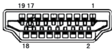
Câble de signal d’affichage couleur à 19 broches
