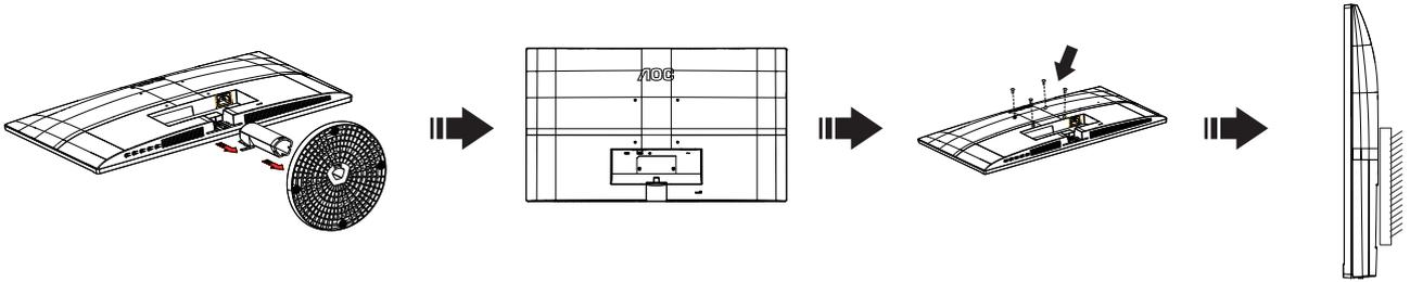
本顯示器可安裝於另購的壁掛支架。安裝前請先拔下電源線。按下列步驟進行：
